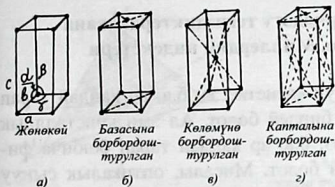
15.3.5-сүрөт. Ромбикалык системанын элементардык ячейкалары: а) – жөнөкөй; б) – базасында борбордоштурулган элементардык уяча. в) – көлөмүндө борбордоштурулган; з) – капталында борбордоштурулган;
